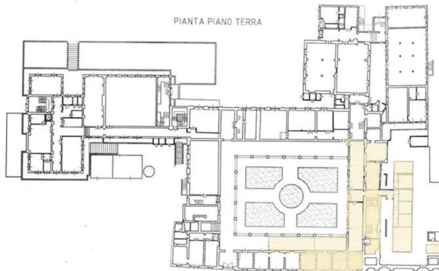
**FIGURA 19.** Pianta del piano terreno del complesso dei Paolotti, dove sono evidenziati gli spazi occupati dall'Istituto di Chimica Organica. Per recuperare spazi mancanti uno dei quattro lati del portico era stato chiuso ed erano stati collocati due prefabbricati, uno nella chiesa e l'altro sotto un altro lato del portico per ospitare i locali di servizio dell'istituto di chimica organica.<sup>6</sup>
