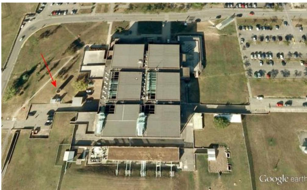
**FIGURA 32.** Vista aerea dell'edificio Chimico, che evidenzia l'importante numero di sistemi di aspirazione (tubi verdi) delle cappe e a sinistra, caratterizzato da una lunga ombra e indicato dalla freccia rossa, il cilindro di ingresso dell'aria dell'edificio, collocato sopravvento rispetto ai venti dominanti. In basso a sinistra la zona deposito esterna, i laboratori esterni e a destra i magazzini esterni.
